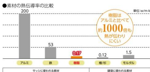
家の中で大きな面積を占めるサッシの性能が低いと、いくら断熱材を強化しても開口部から熱が逃げていきます。当社では従来よりペアガラスの樹脂サッシを採用してきましたが、ZEHの実現に大きく貢献するためにトリプルガラスの樹脂サッシを採用することにより、熱ロスを10%程度削減することができました。
