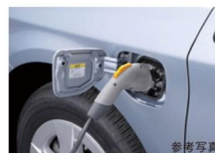
電気自動車等充電コンセント
